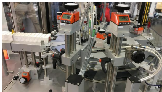
Elesa+Ganter DD52R-E-RF elektronische Stellungsanzeiger an einer Verpackungsmaschine von JW Verpackungstechnik
